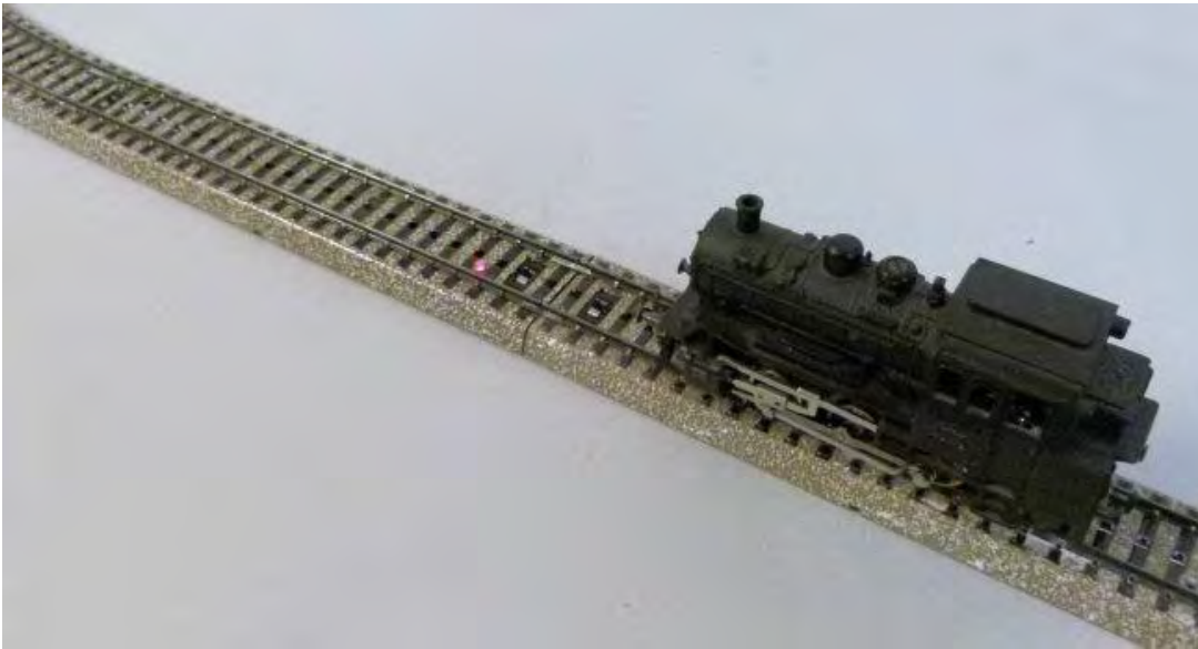
Gleisabschnitt/Unterbrecherschiene mit LED-Signalsierung.
