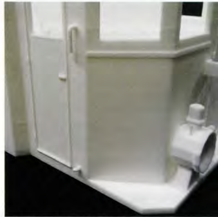
Bild 11 Zu filigrane, freistehende Teile (Handlauf, Lampengriff) können missraten.
